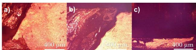
**Şekil 8.** 2080 dev/dk takım dönme hızı ve 54 mm/dk ilerleme hızı kullanılarak birleştirilen levhaların kaynak kesiti üzerinden alınan optik mikroskop görüntüleri
