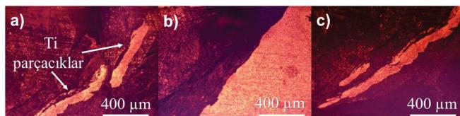
1500 dev/dk takım dönme hızı ve 54 mm/dk ilerleme hızı kullanılarak birleştirilen numunenin optik mikroskop görüntülerini Şekil 5' te yer almaktadır. Al-Ti yapının birleştiği hatta düzgün sayılabilen kadar çizgisel bir hattın varlığı görülmektedir (Şekil 5.b). Ti yapının Al ana kütle içerisinde dahil olduğu Şekil 5.a' da görülmektedir.
