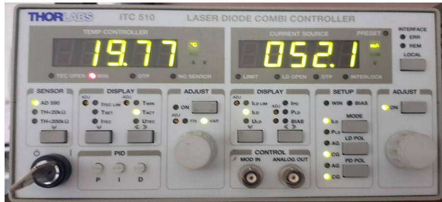
Şekil 16. Lazerleme için kombi kontrolör ayarları.
