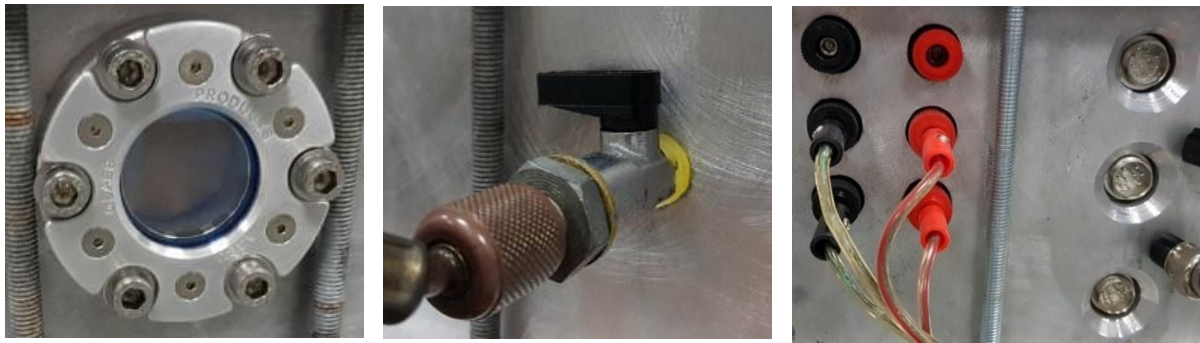
Şekil 6. Vakum penceresi bağlantısı, vakum pompası bağlantı vanası, elektrik ve veri bağlantı konnektörü.
