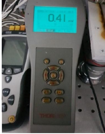
Şekil 21. 25 °C de, Atmosfer basıncında, eşik akımında, harici geri beslemeli lazer ışık gücü Şekil 22. -50.03 °C
