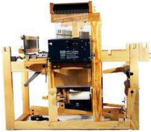
Şekil 2. Studio Dobby Loom yarı-otomatik numune dokuma tezgahı
