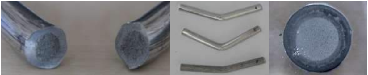
Şekil 6. Tabakalı kompozit malzemenin eğilme kırılması sonrası kesiti, deformasyon miktarı ve kesit görüntüsü.
