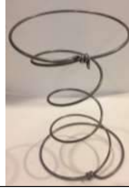
Şekil 4. Geliştirilen tellerden elde edilen yay numunesi
