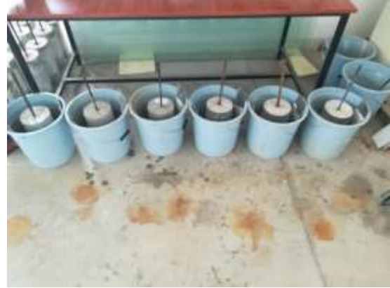
Şekil 5. NaCl çözeltisine konulan donatılı silindir numuneler
