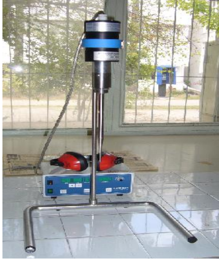
Şekil 3.6. Spirulina 'dan DNA izolasyonu amacıyla hücre duvarını parçalamak için kullanılan sonikatör cihazı
