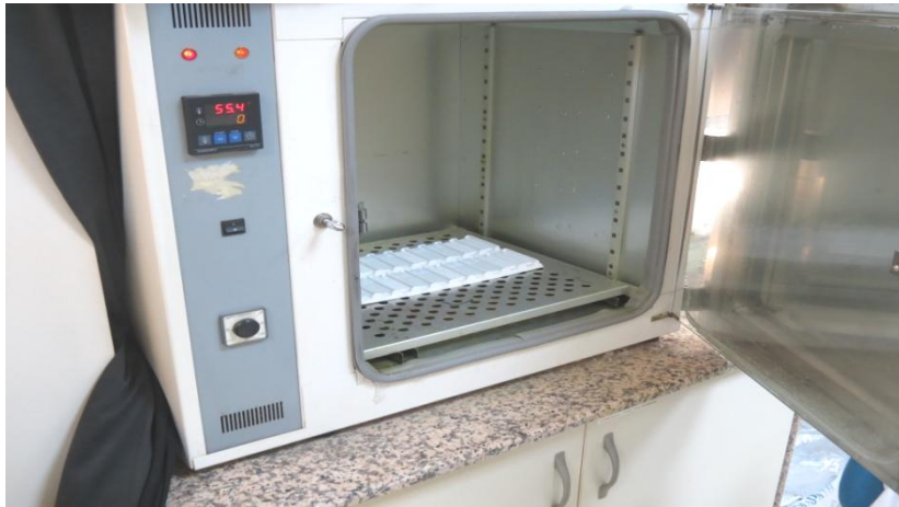
Resim 4: 60 °C etüvde bekletilme aşaması.
