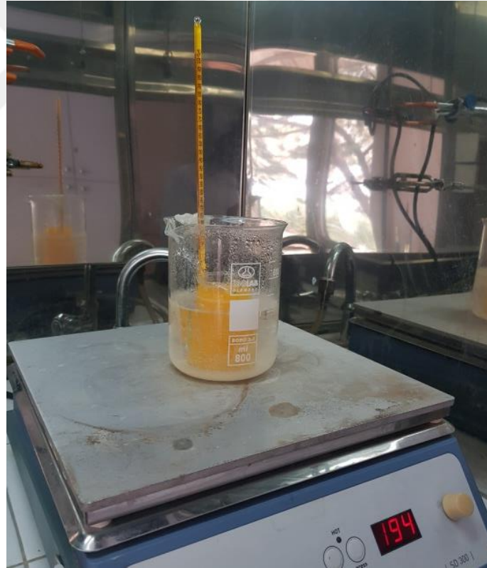
Şekil 3.1. CdS yarıiletken ince filmlerinin kimyasal depolama yöntemiyle elde edilmesi.
