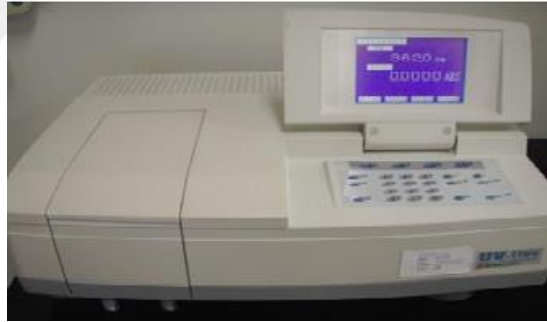
Şekil 3.2. UV-Visible Shimadzu UV-1700 Spektrofotometresi.
