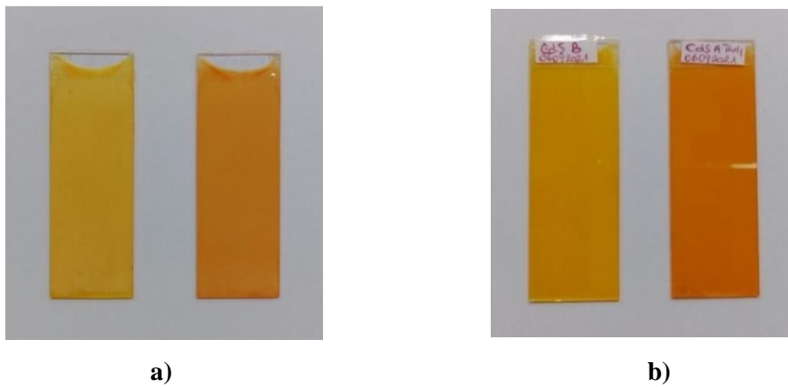
Şekil 4.18. 3. grup NW yarıiletken ince filmlerin a) Film kaplı yönünden b) Cam yüzey yönünden görüntüsü.
