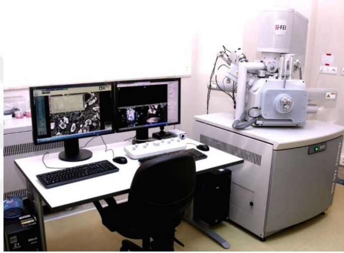
Şekil 3.4. SEM ve EDS cihazı (FEI Quanta 650 Field Emission SEM ve EDS) (SEM).
