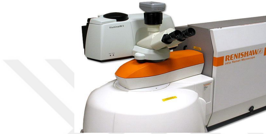
Şekil 3.10. Raman Analizi cihazı (Marka: Renishaw Model: In Via Qontor) (Raman).
