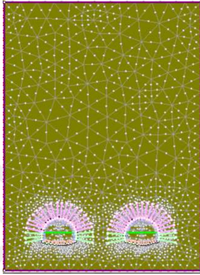
Şekil 4.37. Tünelin destek sistemleri 6 ağılı çözüme hazır hali
