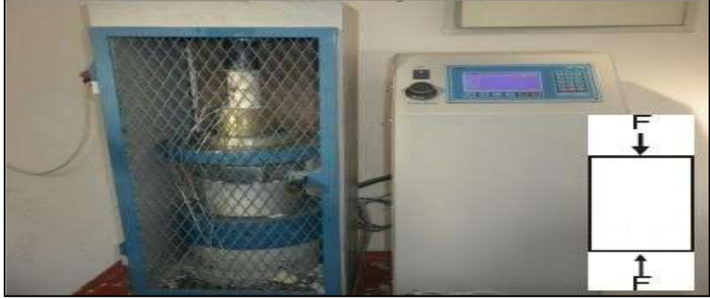
Şekil 3.9. Tek Eksenli Basınç Dayanımı Deney Düzeneği(Tuncay,2012)
