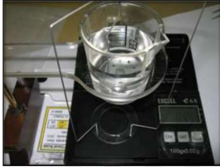
Görsel 2.8: Örneklerin özgül ağırlık tespiti.
