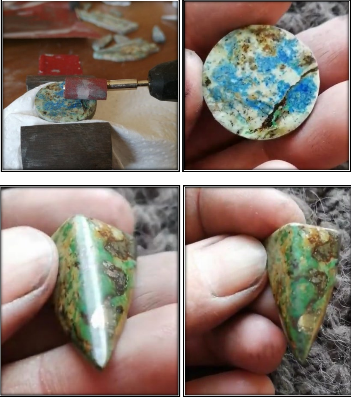
Şekil 4.13. Süstaşı şekillendirme sonrası zımpara çalışmaları.
