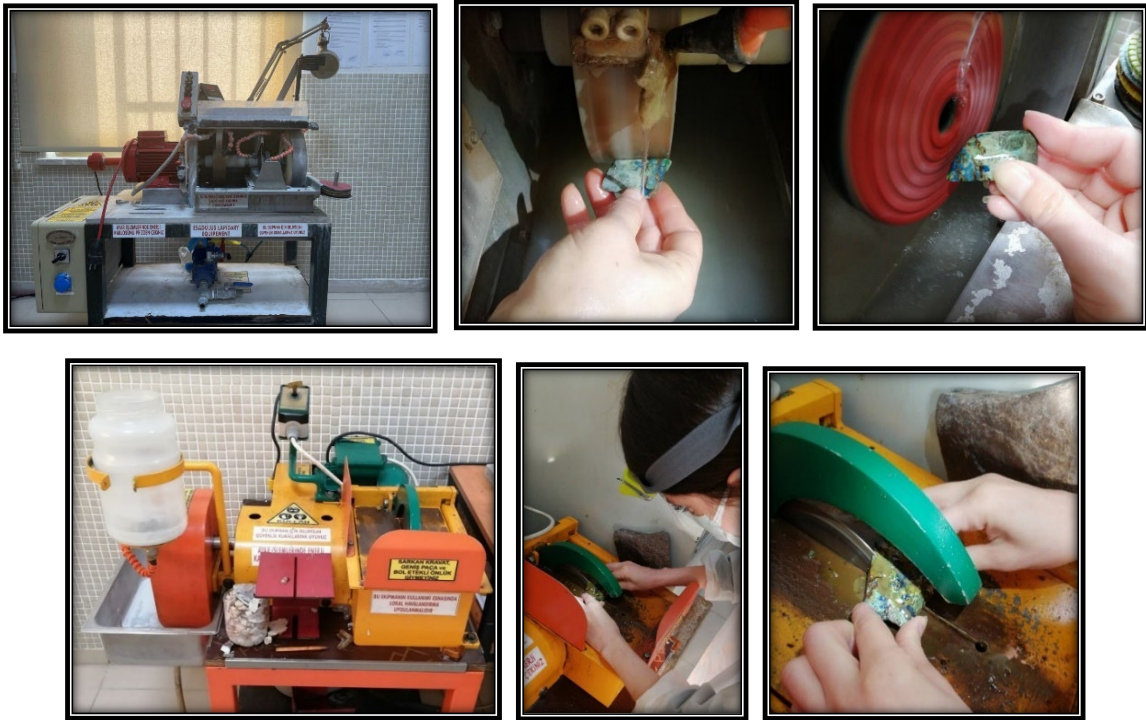
Şekil 4.11. Esadulus Lapidary Machine de dilim alma, aşındırma ve şekillendirme çalışmaları.
