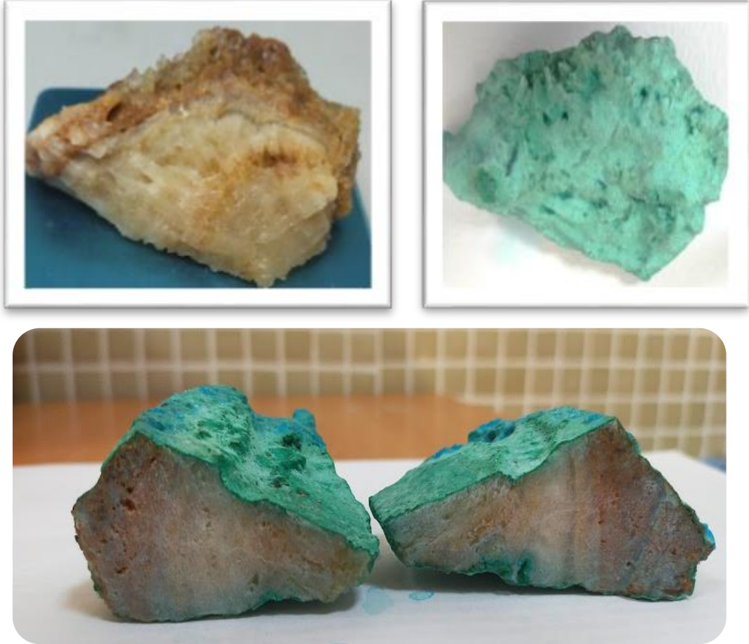
Şekil 4.5. Bakır Sülfat içinde bekletilen kalsit kristali (35 Gün sonra)
