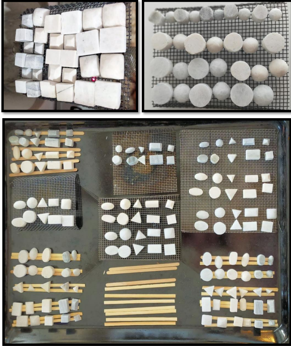
Şekil 4.16. Beyaz(A), bej (B) ve gri (C) mermerlerin ısıtılma aşaması.
