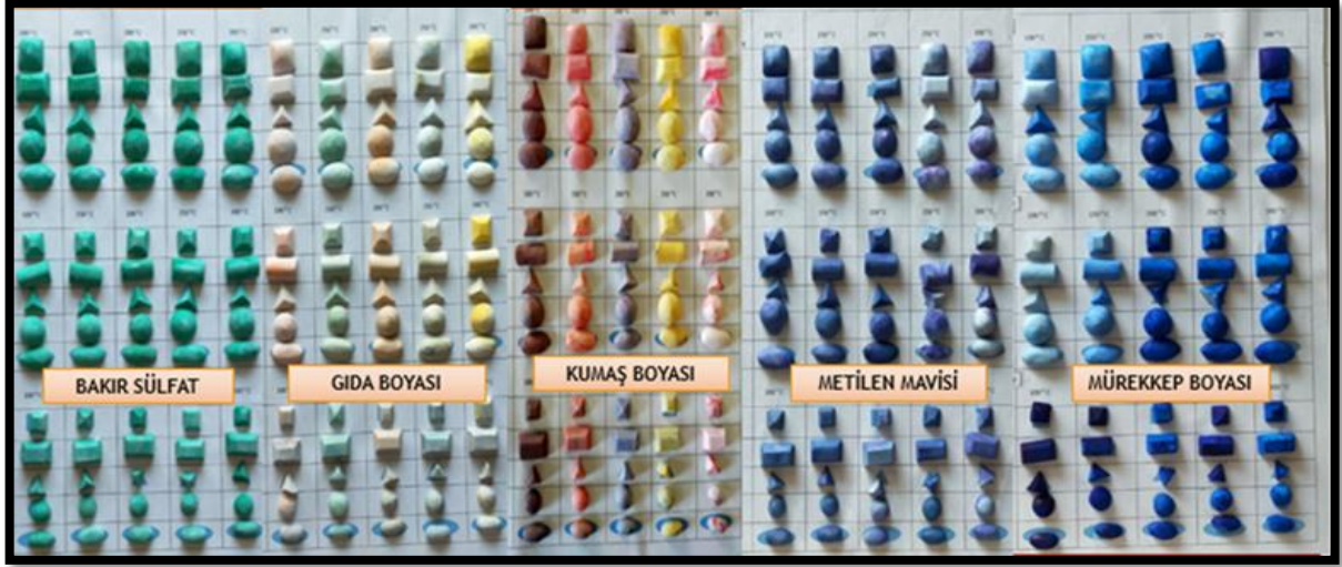
Şekil 4.18. Boya solüsyonları bekletilerek renklenmiş mermerler.
