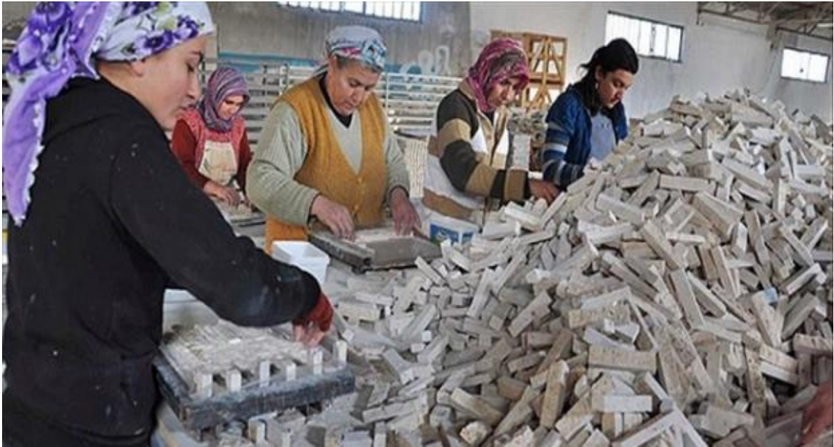
Şekil 2.11. Mermer fabrikası paledyen atıkları ve farklı alanlarda kullanılmak üzere ayırma işlemleri ( https://haberveinsan.com/mermer-atiklari- http://www.eskisehir.net.tr/haber/ )
