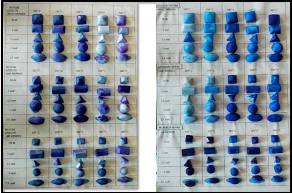
Şekil 4.20. Metilen mavisi ve mürekkep boya çözeltilerinde bekletilerek renklendirilmiş mermerler.
