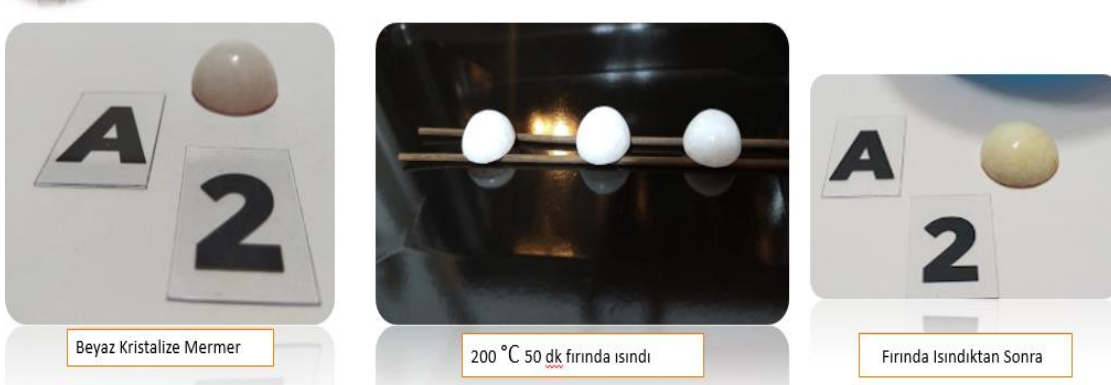
Şekil 4.7. Beyaz kristalize mermerin ısınma öncesi ve sonrası
