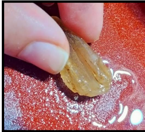
Şekil 3.7. Kalsit kristalinin şekillendirme aşamalarından 100 numaralı kağıt zımparada yapılan işlem.
