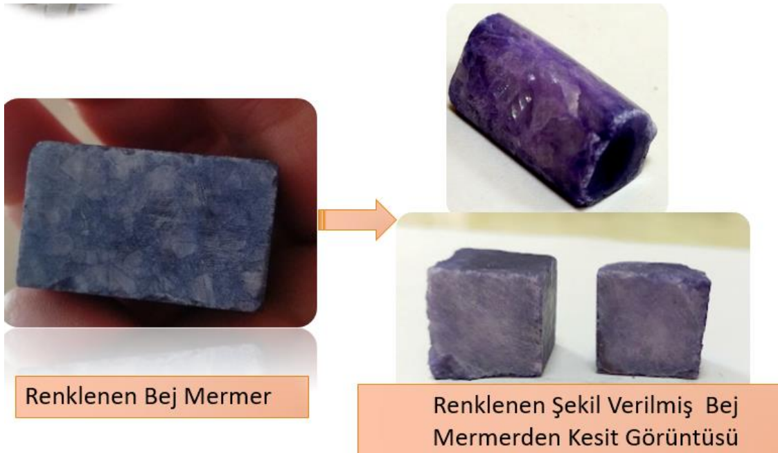
Şekil 4.13. Renklendirilen Bej Mermerin 22 Gün tamamen içine boyayı aldığı gözlemlenmiştir
