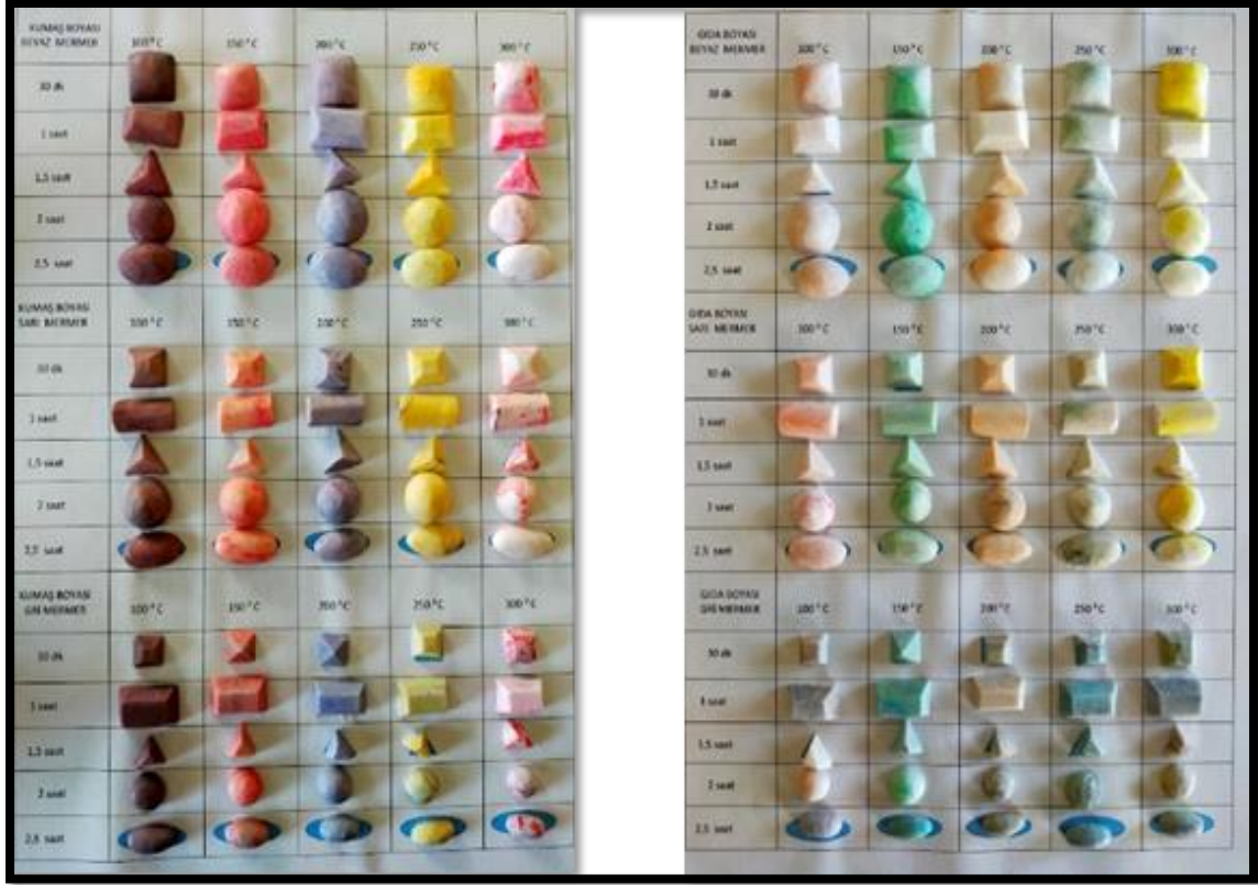
Şekil 4.19. Kumaş ve gıda boya çözeltilerin de bekletilerek renklendirilmiş mermerler.
