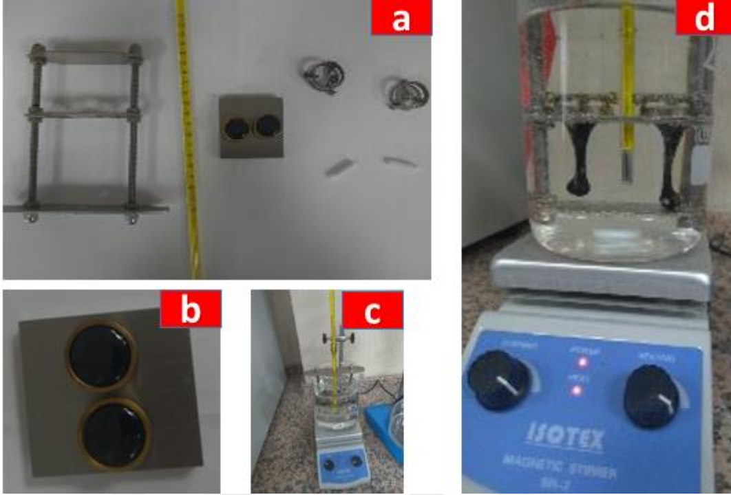
Resim 3.9 Bitüm yumuşama noktası deneyi yapılış aşaması a) deneyde kullanılan aparatlar, b) bitümün yüzüklere yerleştirilmesi, c) yüzüklerin cihaz içerisine yerleştirilmesi ve deneye başlanması, d) bitümün düzeneğin taban yüzeyine teması.
