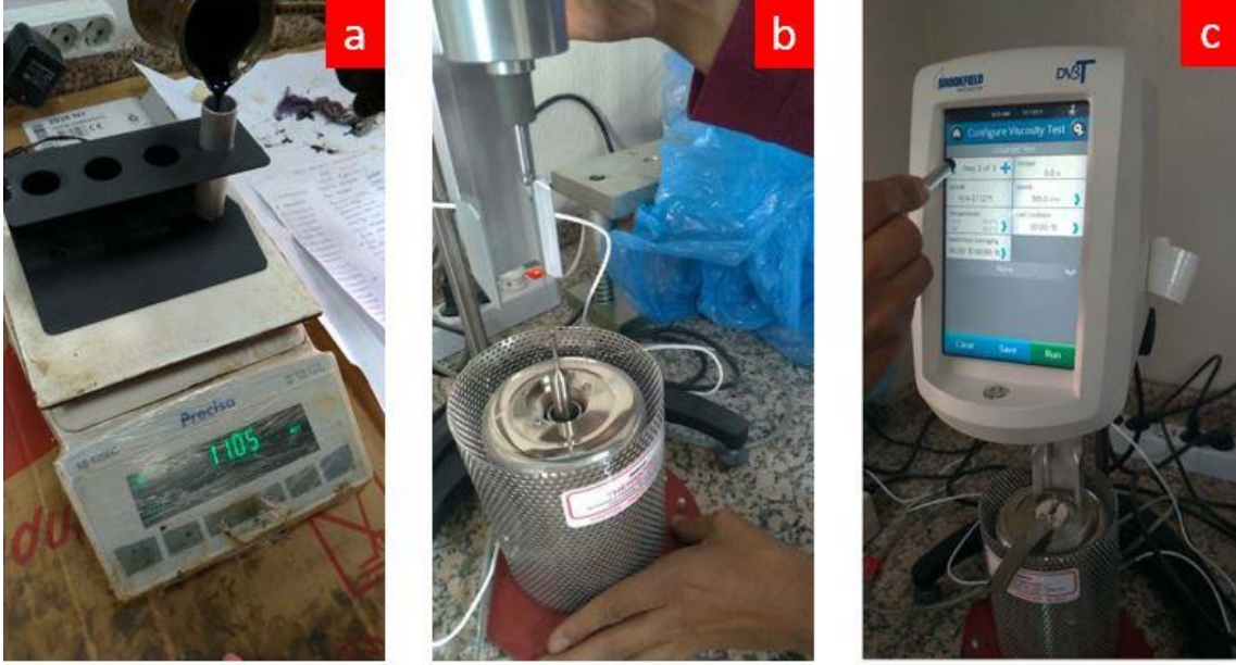
Resim 3.10 Dönel viskozite deneyinin yapılış aşaması a) bitümün tüpe dökülmesi, b) Spindle'nin tüp içerisine terazili şekilde yerleştirilmesi, c) deneyin başlatılması.
