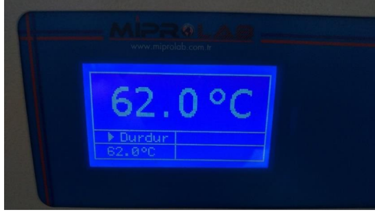
Resim 3.3 AKÜ UV yaşlandırma cihazının çalışma sıcaklığı.
