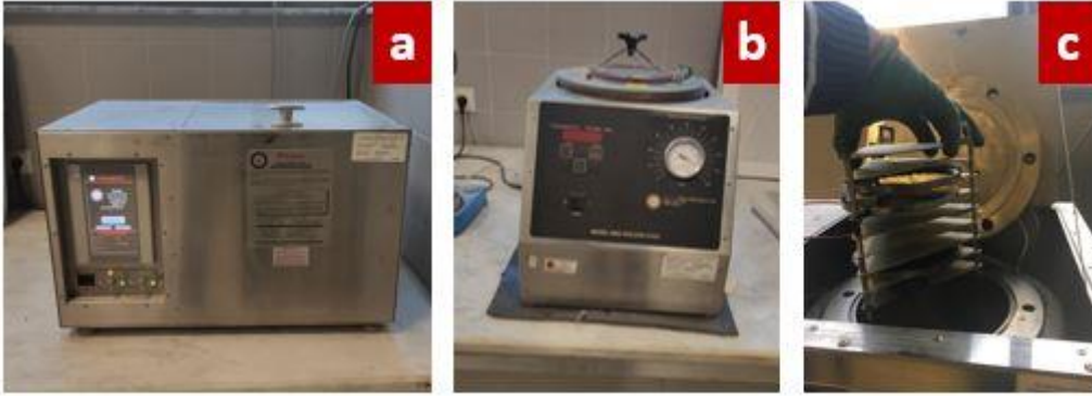
Resim 3.12 a-b) PAV deneyi, c) Numune rafının PAV cihazına yerleştirilmesi.
