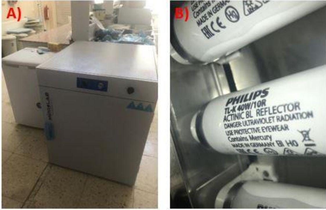
Resim 3.5 a) AKÜ UV yaşlandırma cihazı, b) AKÜ UV yaşlandırma cihazının lamba özellikleri.
