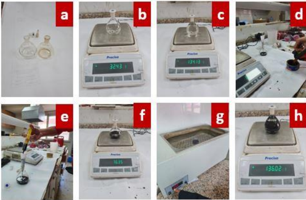
Resim 3.7 Bitüm Özgöl Ağırlık piknometresi deney aşamaları, a)deneyde kullanılacak piknometre kapları, b) boş piknometre kabının tartılması, c) su dolu piknometre kabının tartılması, d-e) piknometre kabı içerisine bitüm numunesinin doldurulması, f) bitüm dolu piknometre kabının tartılması, g) bitüm doldurulmuş piknometre kabının 25±0.5 °C su banyosunda 30 dakika bekletilmesi, h) su banyosundan çıkarılan piknometre kabının tartılması.
