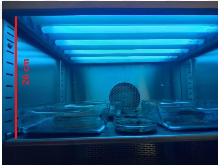
Resim 3.4 UV yaşlandırma cihazı içerisindeki bitüm numuneleri ve UV lamba mesafesi.
