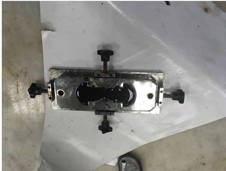
Resim 3. 15 Düktilite kalıbı içerisine numunenin yerleştirilmesi.
