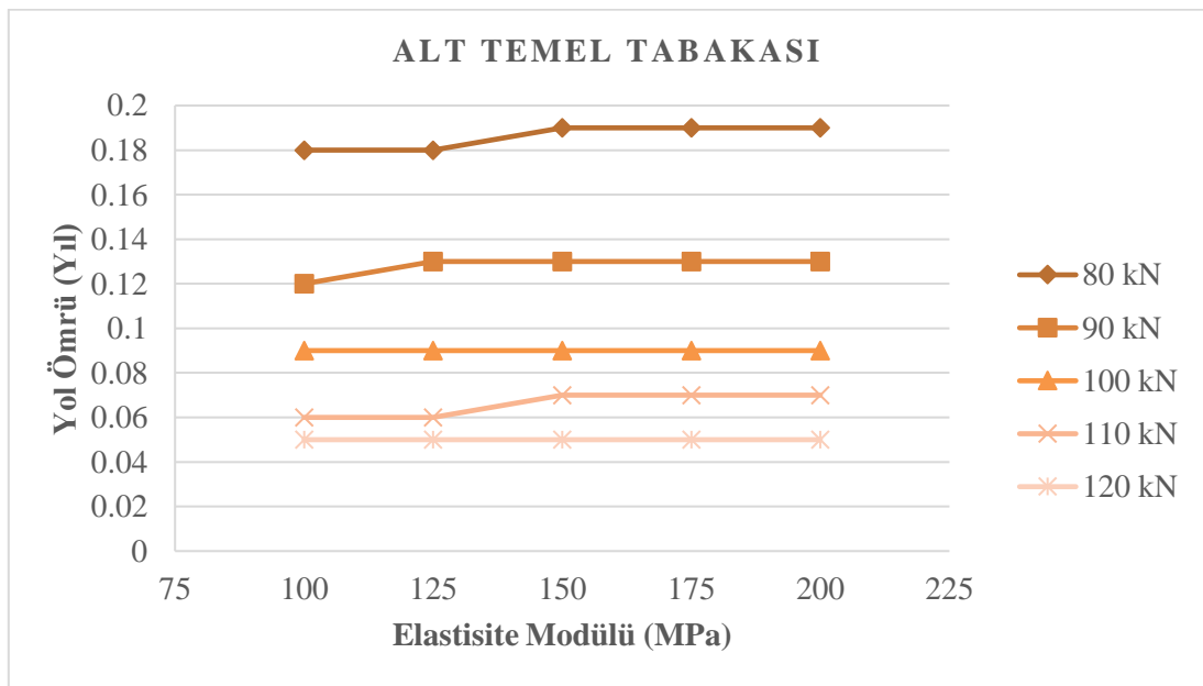
Şekil 4.84. Alt temel tabakasının elastisite modülü değişimine göre yol ömrünün değişimi (3. Model).
