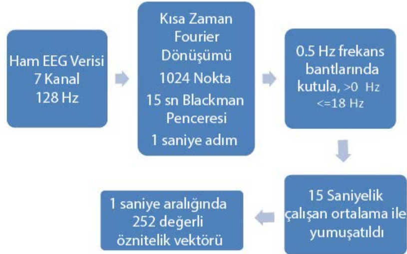
Şekil 4. Öznitelik çıkarma adımının blok şeması.
