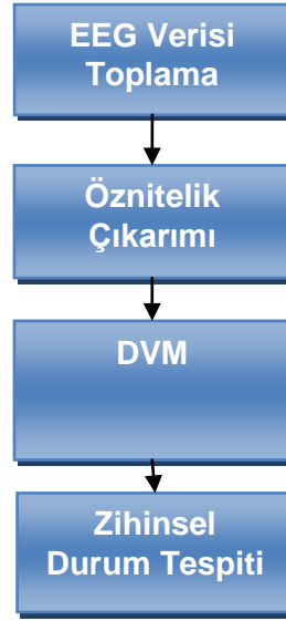
Şekil 3. Zihinsel dikkat durumu algılayıcısının blok şeması.
