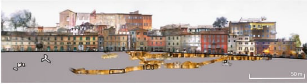
Şekil 3.11. Yeraltı mağaraları ile Camerano (İtalya) şehir merkezinin düşey kesiti (Di Stefano, vd., 2021).
