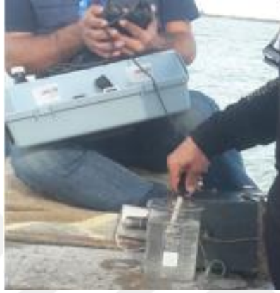
Şekil 3.4. İstasyonlarda Alınan Su Numunelerinin Anlık Ölçümü
