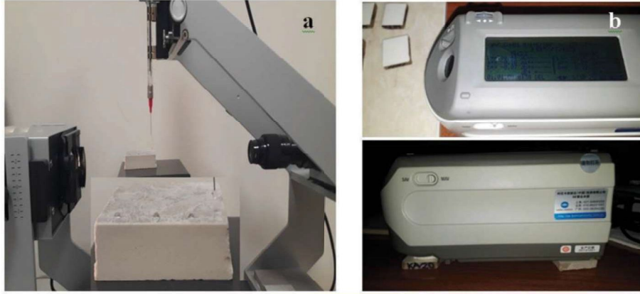
Şekil 2: a) Temas açısı ölçüm sistemi, b) renk ölçüm sistemi
