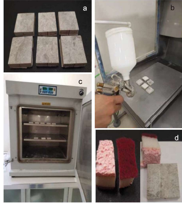
Şekil 1. a) Kesilerek hazırlanmış porselen karo numuneleri, b) Spreyleme ile kaplama işlemi, c) Etüvde kurlama süreci, d) Süngerler ve kimyasal uygulama işlemi
