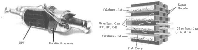
Şekil 1. a) Dizel araçlarda kullanılan egzoz filtreleme sistemi [2], b) Dizel partikül filtre iç yapısı ve çalışma prensibi [4].
