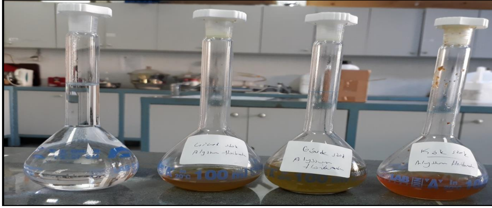
Şekil 3.4. A. floribundum bitki ekstraktlarının etanol ile hazırlanan stok çözeltileri.
