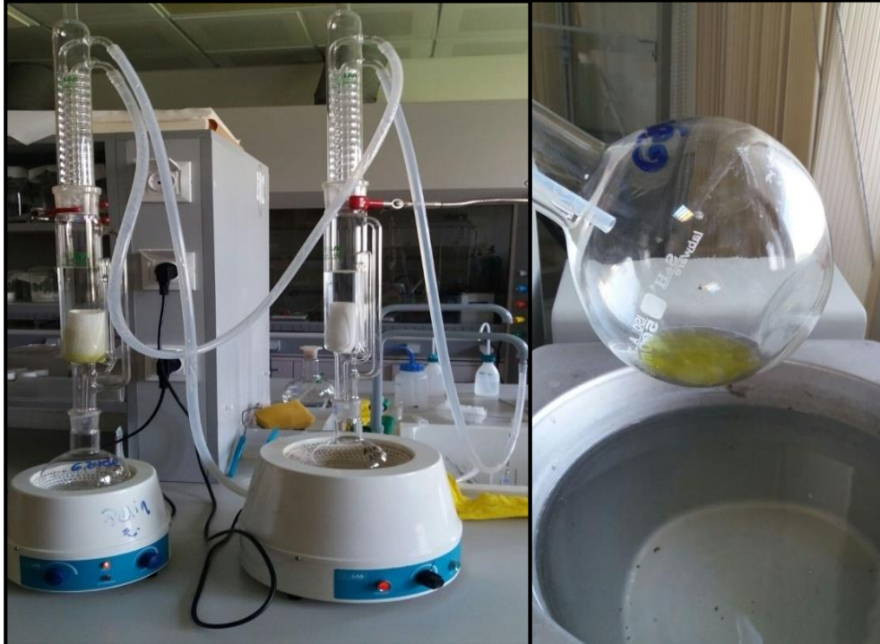
Şekil 3.2. A. floribundum bitkisinin kök, çiçek, gövde ve yaprak kısımlarının sokshlet cihazında ekstraksiyon işlemi ve rotary evaporatörde çözücülerin uzaklaştırılması işlemi.
