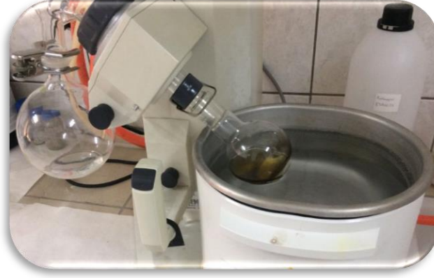
Şekil 3.3. Evaporatör ile bitki özütlerinden çözücünün uzaklaştırması.
