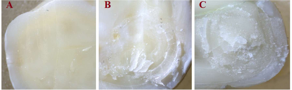
A- Adeziv kırılma B- Mix kırılma C- Koheziv kırılma
