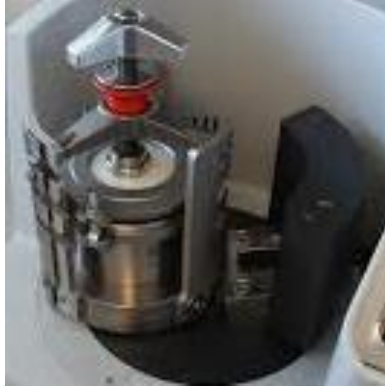
Şekil 2.23. Tek kavanozlu gezegenel bilyeli öğütücü.
