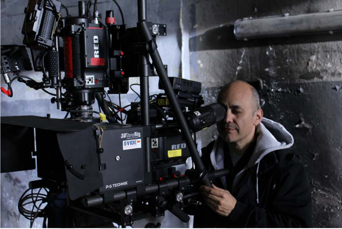
Fotoğraf 44. P+S Technik 3D Stereo yarı geçirgen aynalı rig üzerine 2 adet Red One ve Zeiss HS prime lensler yerleştirilerek hazırlanmış üç boyutlu kayıt düzeneği (Doğan Sarıgüzel arşivi)
