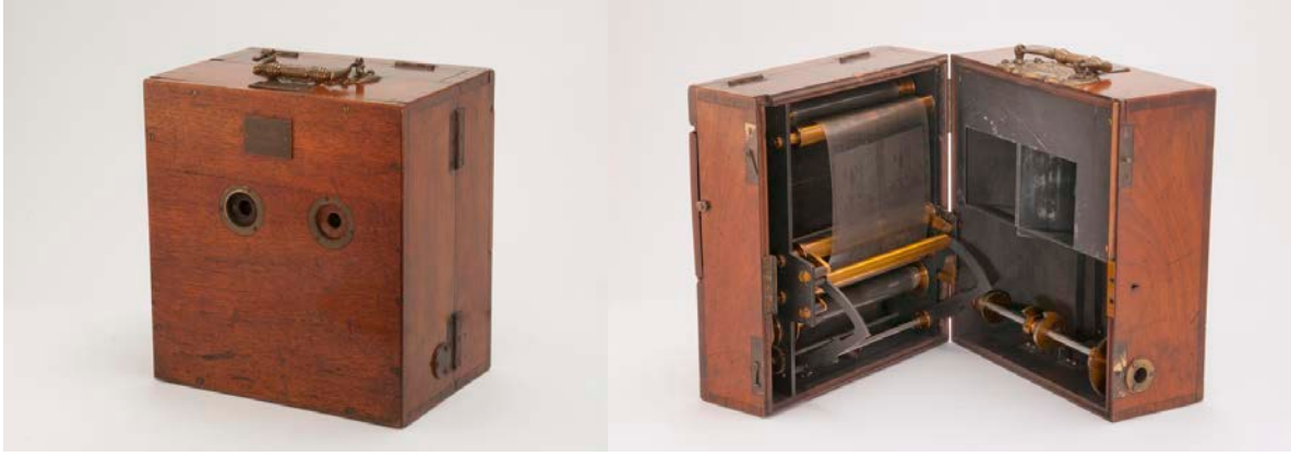
Fotoğraf 16. William Friese- Greene ve Frederik Henry Varley stereoskopik film kamerası (1890) (Stereo-cine Camera, 2016)
