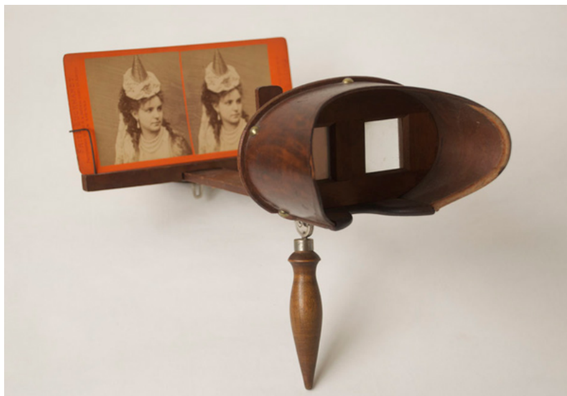
Fotoğraf 4. Oliver Wendell Holmes'ın geliştirdiği pratik kullanımlı stereoskop (The Scientific "Magic" Behind Stereoviews' 3-D Realism, 2015)
