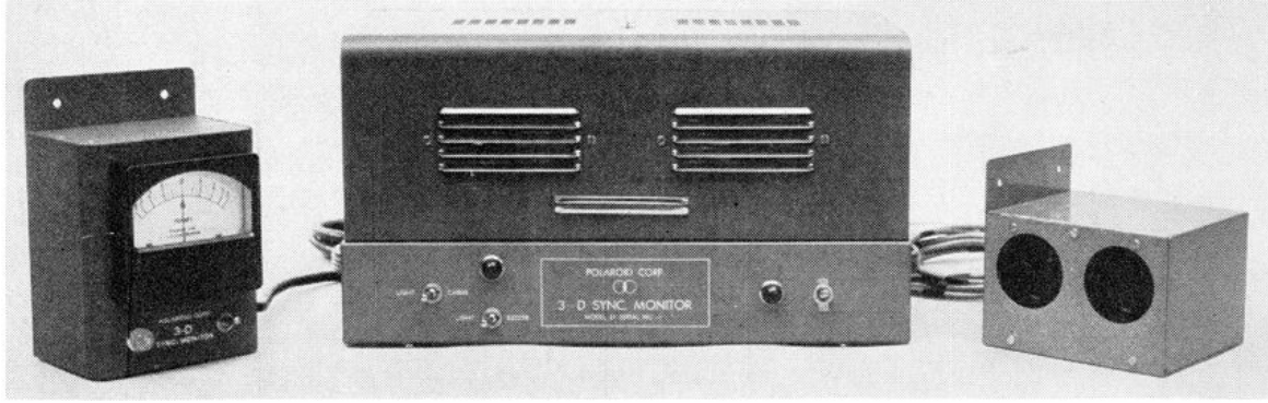
Fotoğraf 28. Polaroid firmasının ürettiği üç boyutlu filmlerin senkronizasyon sorunlarını tespit edip uyarı verebilen elektronik senkronizasyon monitörü (Restoring A Landmark 3-D Motion Picture, 2011)
