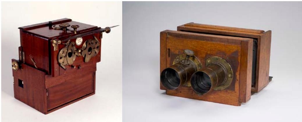
Fotoğraf 5. John Benjamin Dancer'in binoküler kamerası 1856 (solda), Mathew Brady'nin binoküler kamerası 1864 (sağda) (Photography in Stereo, 2015)
