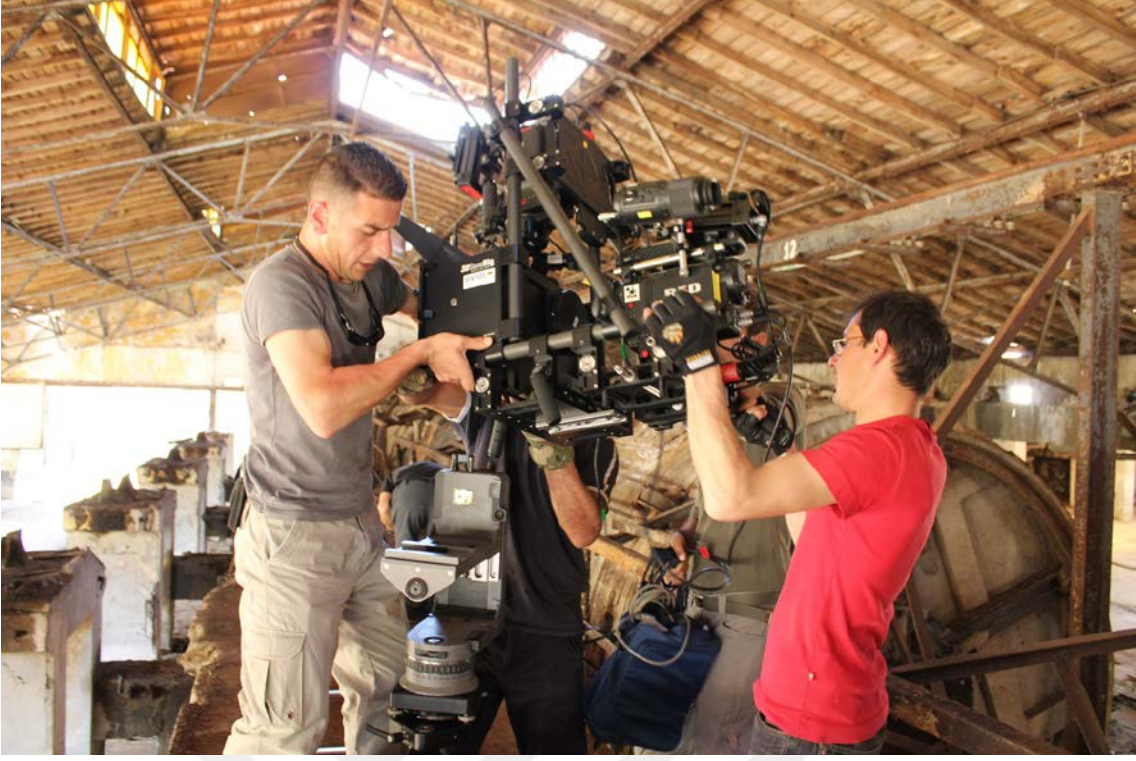
Fotoğraf 46. Cehennem 3D filmi kamera ekibi, yarı geçirgen ayna donanımına sahip olan stereoskopik üç boyutlu rigi taşıırken (Doğan Sarıgüzel arşivi)
